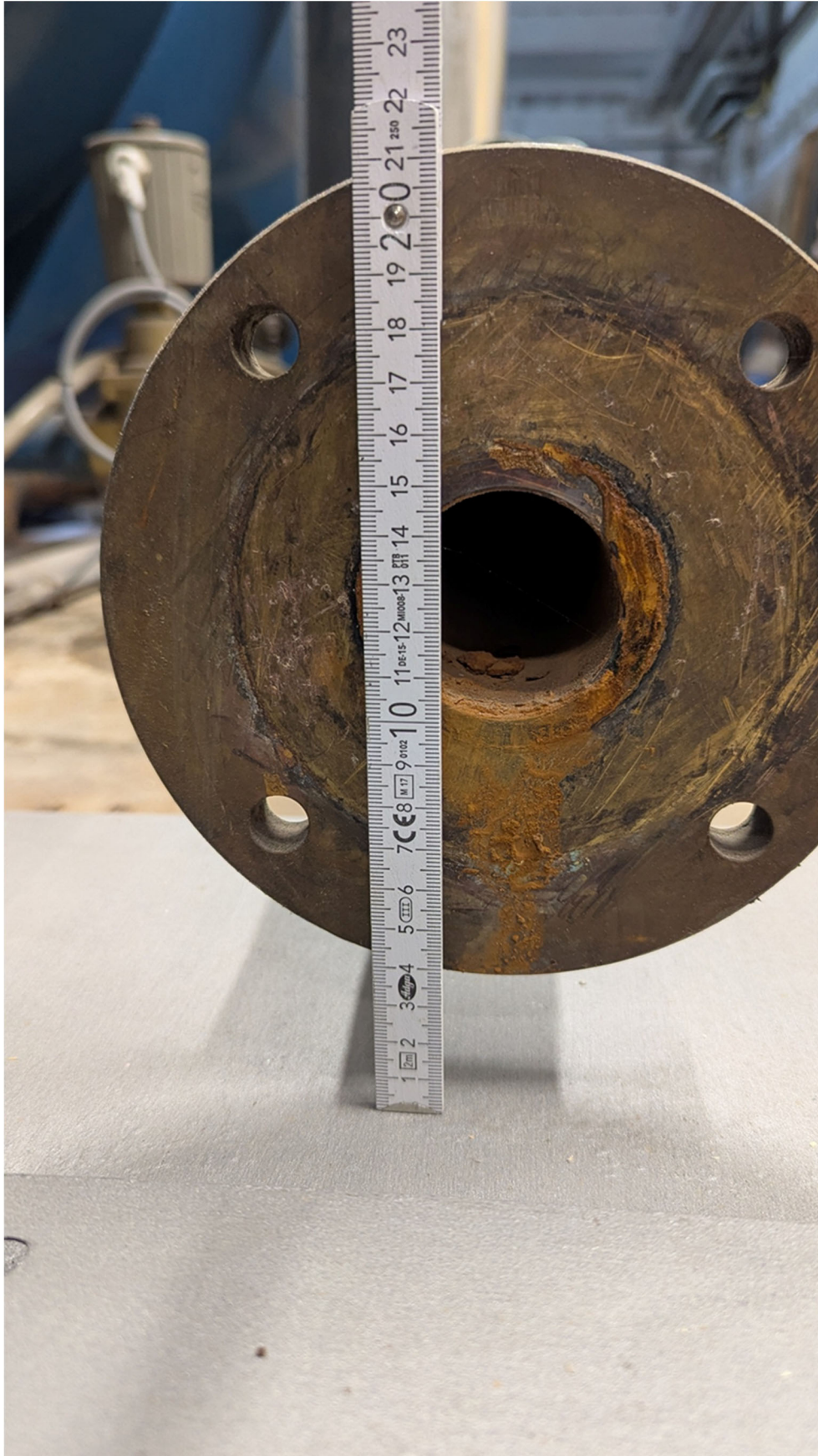
Abbildung 8: Höhe Zulauf Pumpe
